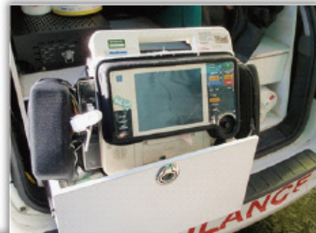
(圖四) 多功能生命表徵監察儀器，可量度血壓、脈搏、血含氧量及十二線心電圖，亦可進行心臟電擊去顛術 (Defibrillation)，同步心臟整流 (Synchronized Cardioversion) 和心臟起搏 (Pacing)
